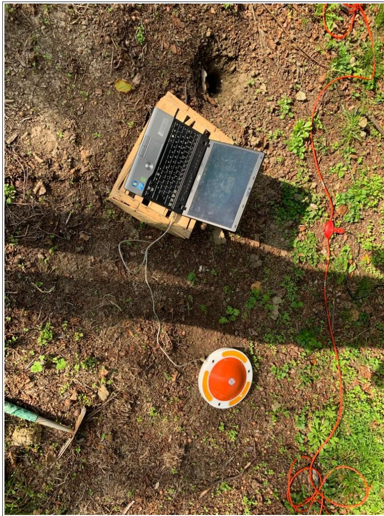
Acquisizione punto sismico congiunto MASW-REMI-HVSR
